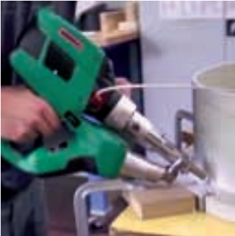
Компактный экструдер WELDPLAST S1 с возможностью сварки ПЭ, ПП, ПВХ.
