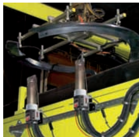
Нагреватель LHS 61 в установке очистки деталей из пластмасс направленным потоком горячего воздуха.
