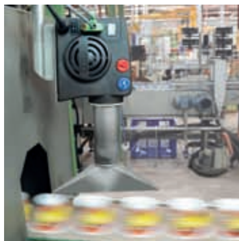
Тепловентилятор HOTWIND SYSTEM в процессах сушки, стерилизации и термоусадки.
