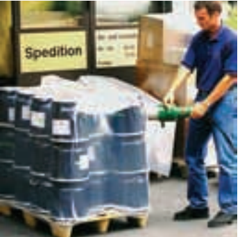
Усадка аппаратом FORTE S3 термоусадочной пленки на палетах перед транспортировкой.
