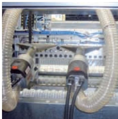
Воздухонагреватели LHS 61S с широкой щелевой насадкой в упаковочной линии.
