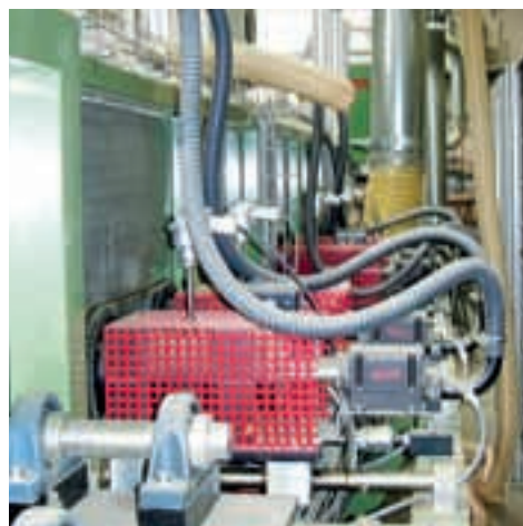
Воздухонагреватели LHS производственной линии для теплоизоляции.
