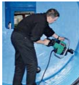
Ручной экструдер WELDPLAST S6 легко направляется при помощи практичной рукоятки.
