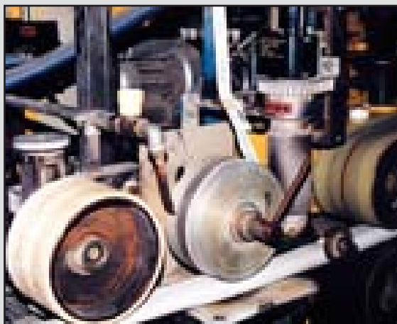
Нагреватели 5000 при сварке бесконечного шланга и ПВХ.
