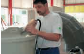
Сварка прутком компактным, высокопроизводительным ручным аппаратом ВЕЛДИНГ ПЭН R.
