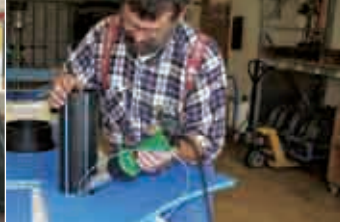
Сварка фасонного изделия ручным аппаратом ТРИАК PID с насадкой быстрой сварки.
