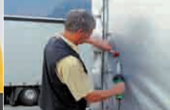
Аппарат ТРИАК PID с щелевой насадкой и прикаточный ролик при ремонте тентового покрытия грузового автомобиля.
