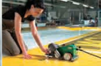
УНИПЛАН Е при сварке внахлест рекламного баннера.
