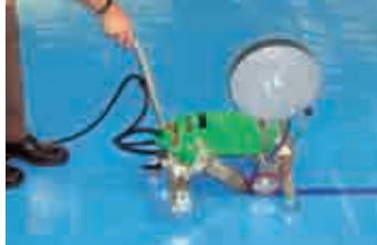
Автомат УНИМАТ для сварки лентой при наварке упрочняющей ленты 40 мм на ПВХ-ткань.
