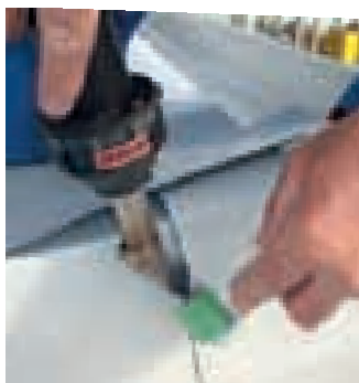
Маленький и легкий аппарат HOT JET S отлично подходит для сварки в узких и труднодоступных местах.
